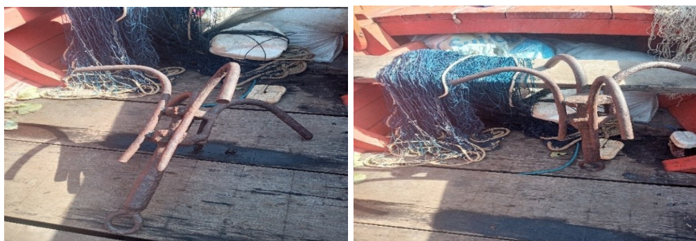
Figura 1 - Garatéia utilizada para fixação da rede de emalhar.
