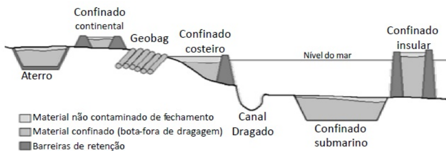
Figura 8 - Tipos de Confinados de Disposição de material dragado (CDF).
