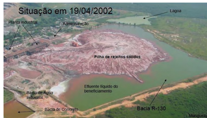
Figura 2 - Passivo ambiental (metais pesados e dique) da Cia. Ingá Mercantil, Itaguaí (RJ).
